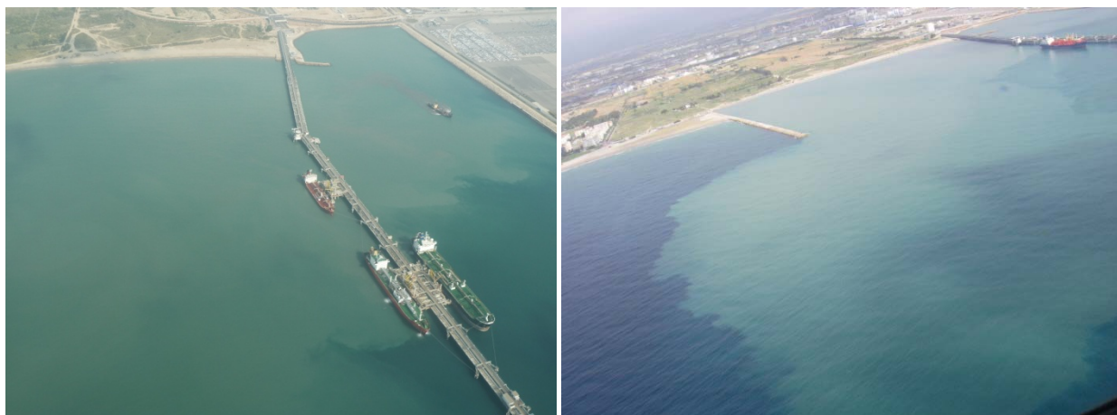
Taca d'aigües tèrboles a la platja dels Prats de Vila-seca a conseqüència de les obres del port de Tarragona (24 i 28-08-2011)
