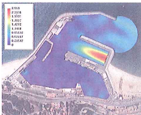
Diagrama d'agitació per un temporal determinat abans de la construcció del martell de la dàrsena pesquera
