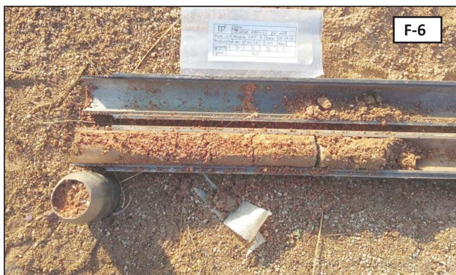
Fotografies 5 i 6: Vista dels materials extrets en l'assaig SPT-3 fet durant la realització del sondeig S-1 entre les cotes de -6.00 a -6.60 metres i en l'assaig SPT-4 entre les cotes de -8.00 a -8.60 metres.
