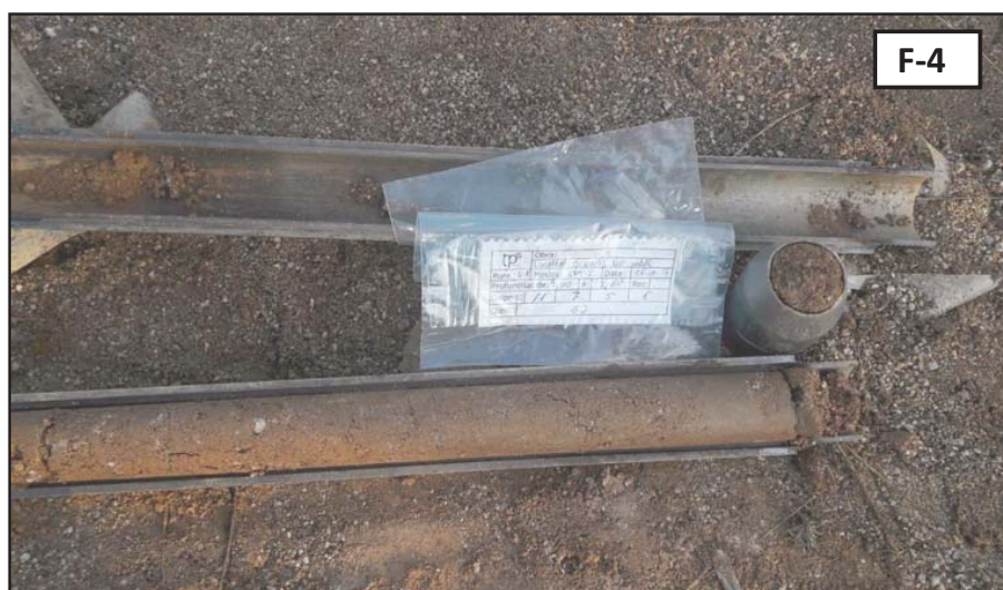
Fotografies 3 i 4: Vista dels materials extrets en l'assaig SPT-1 fet durant la realització del sondeig S-1 entre les cotes de -2.00 a -2.60 metres i en l'assaig SPT-2 entre les cotes de -4.00 a -4.60 metres.
