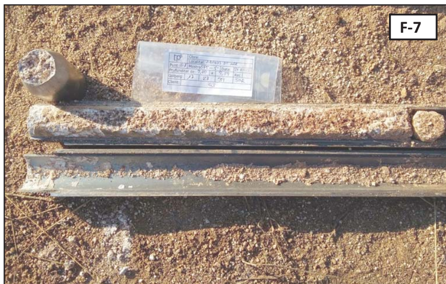
Fotografia 7: Vista dels materials extrets en l'assaig SPT-5 fet durant la realització del sondeig S-1 entre les cotes de -9.00 a -9.59 metres.
