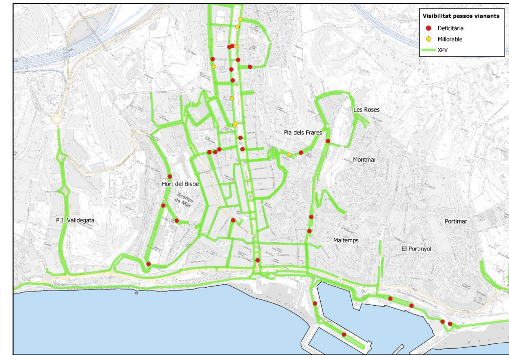
Figura 125. Interseccions amb un dèficit de visibilitat a la XPV
