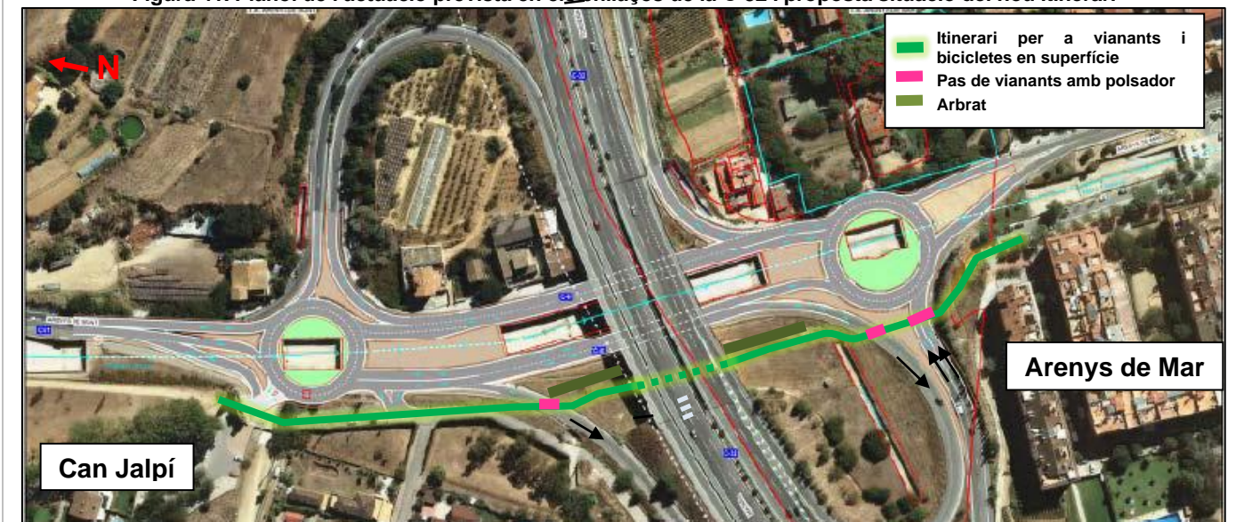
Figura 41. Plànol de l'actuació prevista en els enllaços de la C-32 i proposta situació del nou itinerari
